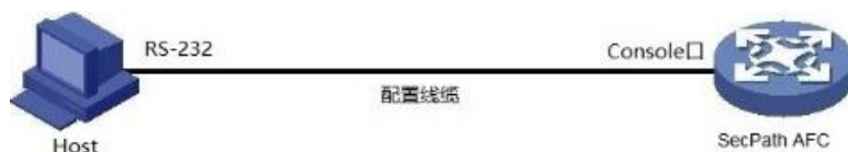
图1-15 将设备与 PC 通过 Console 通信线缆进行连接
