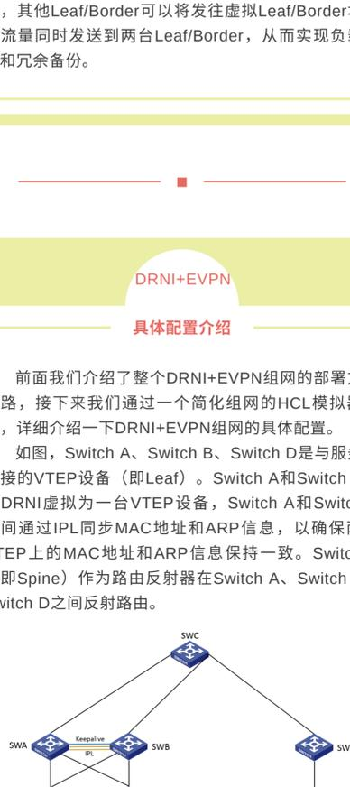
如图，Leaf作为VTEP或者EVPN网关，实现服务器之间二三层流量的转发，通过部署DRNI使服务器双归接入VTEP或EVPN网关，避免单条链路故障导致虚拟机无法访问网络；
