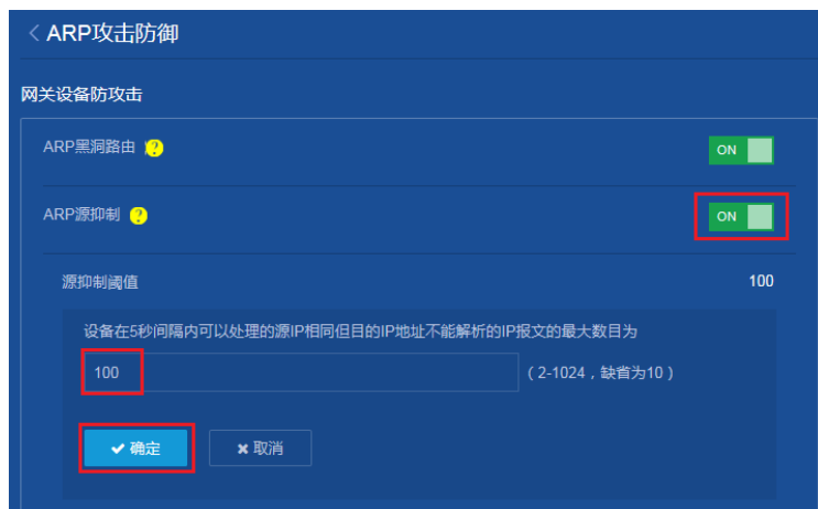
图4 开启 ARP 源抑制功能并配置 ARP 源抑制的阈值
