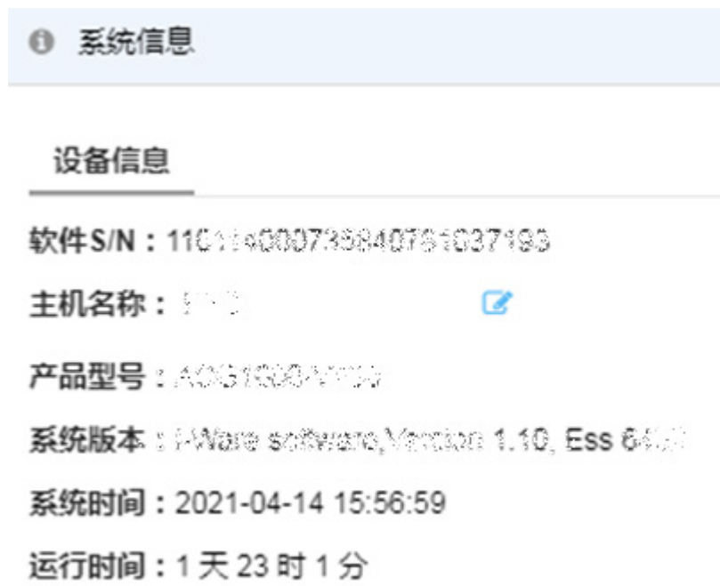
图4-31 ACG1000-V 虚拟产品信息示意图，在“主页 > 系统信息”页面（此截图适用于 VACG E6453 版本及以后版本）
