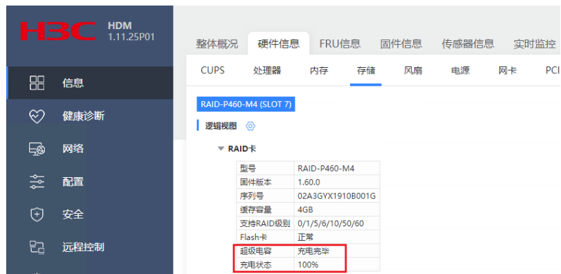
图 6 检查阵列卡电池状态
