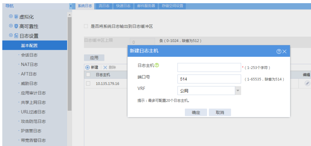
图4-4 IPS 设备新增系统日志主机页面
