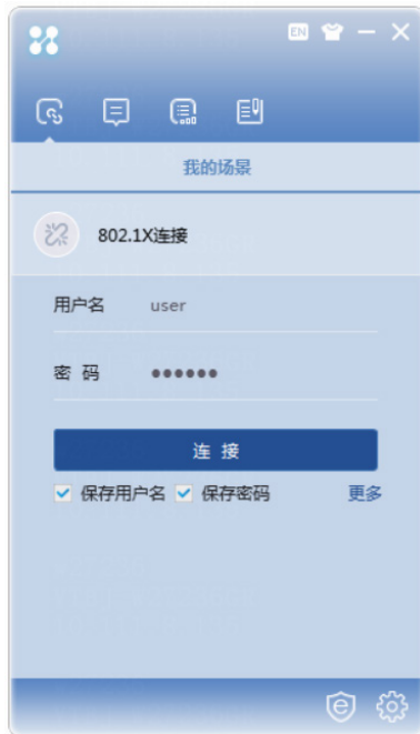
图31 802.1X 客户端连接示意图
