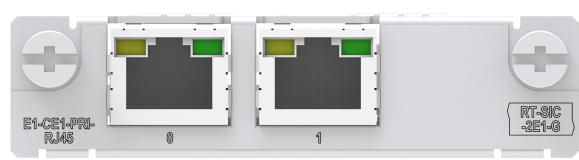
图1-14 RT-SIC-2E1-G 模块面板
