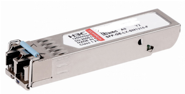
图16-1 SFP28 全光 3.0 专用光模块外观示意图
