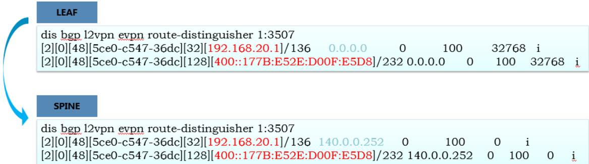
Leaf 设备上终端的 128 位主机路由(ND)可以通过 EVPN 协议同步到 Spine 设备上,并加入到 IPv6 路由表中
