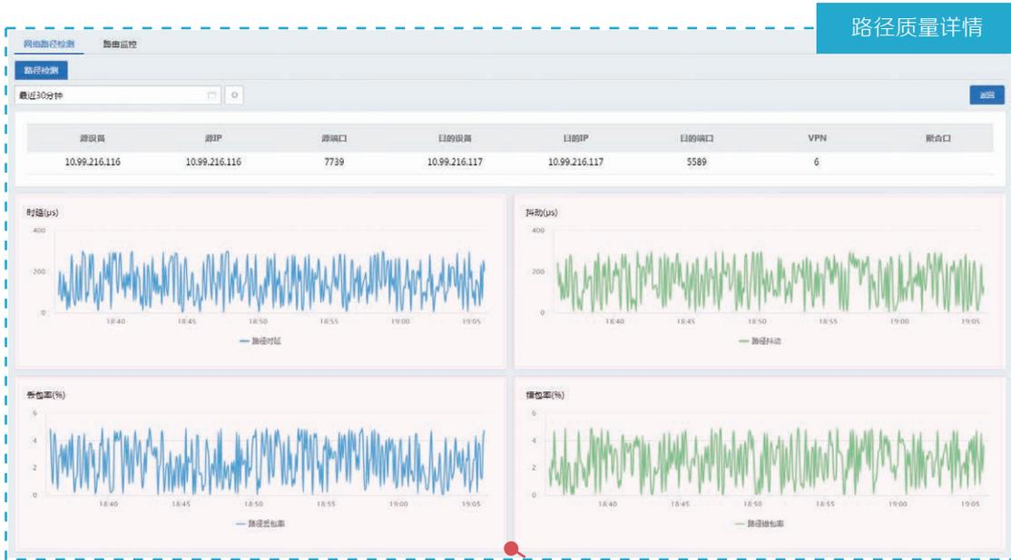
时延/抖动/丢包率/错包率趋势图：展示所选时间段内当前TWAMP测试会话的双向抖动/时延、丢包率以及错包率的变化趋势。
