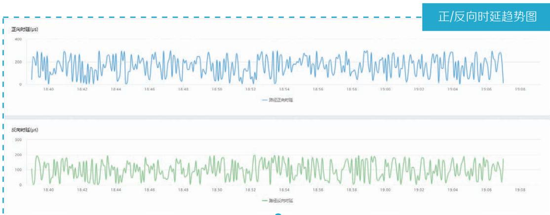
正/反向时延趋势图：展示所选时间段内当前TWAMP测试会话的正向时延与反向时延变化趋势；正向时延表示源设备到目的设备方向的时延大小；反向时延表示目的设备到源设备方向的时延大小。
