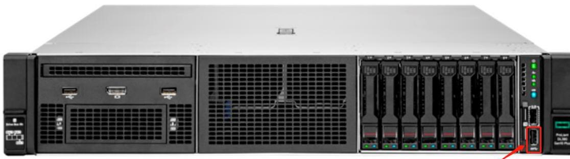
注：请勿将启动 U 盘连接到虚框标识的 iLO USB 服务接口。引导 U 盘的可用接口标识为
