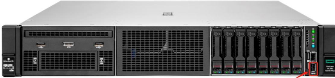
注：请勿将启动 U 盘连接到虚框标识的 iLO USB 服务接口。引导 U 盘的可用接口标识为  $\leftarrow$  和  $\rightarrow$ 。
