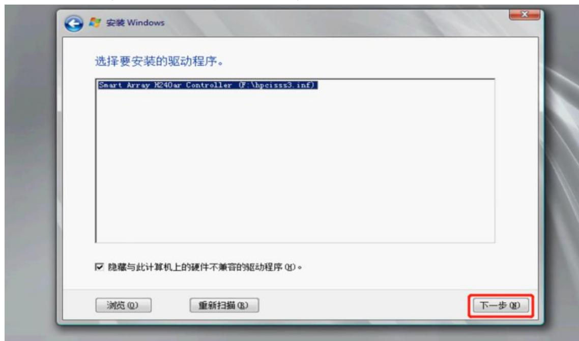
2.12 显示出磁盘，可以自定义设置分区。选择系统安装位置，点击**下一步**。
