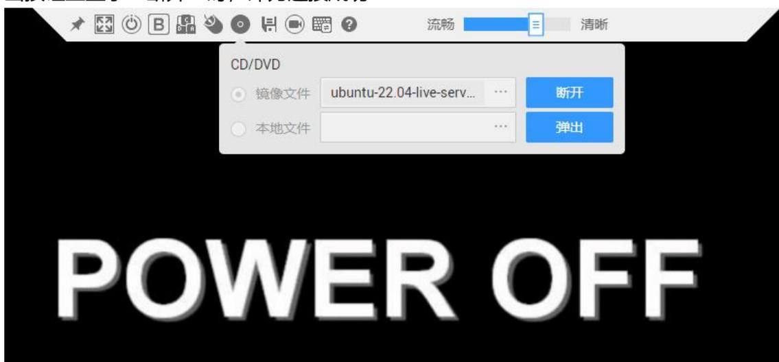
注：文件读取进度可能不会一次性全部加载，待开始引导系统文件后加载进度将继续读取。
