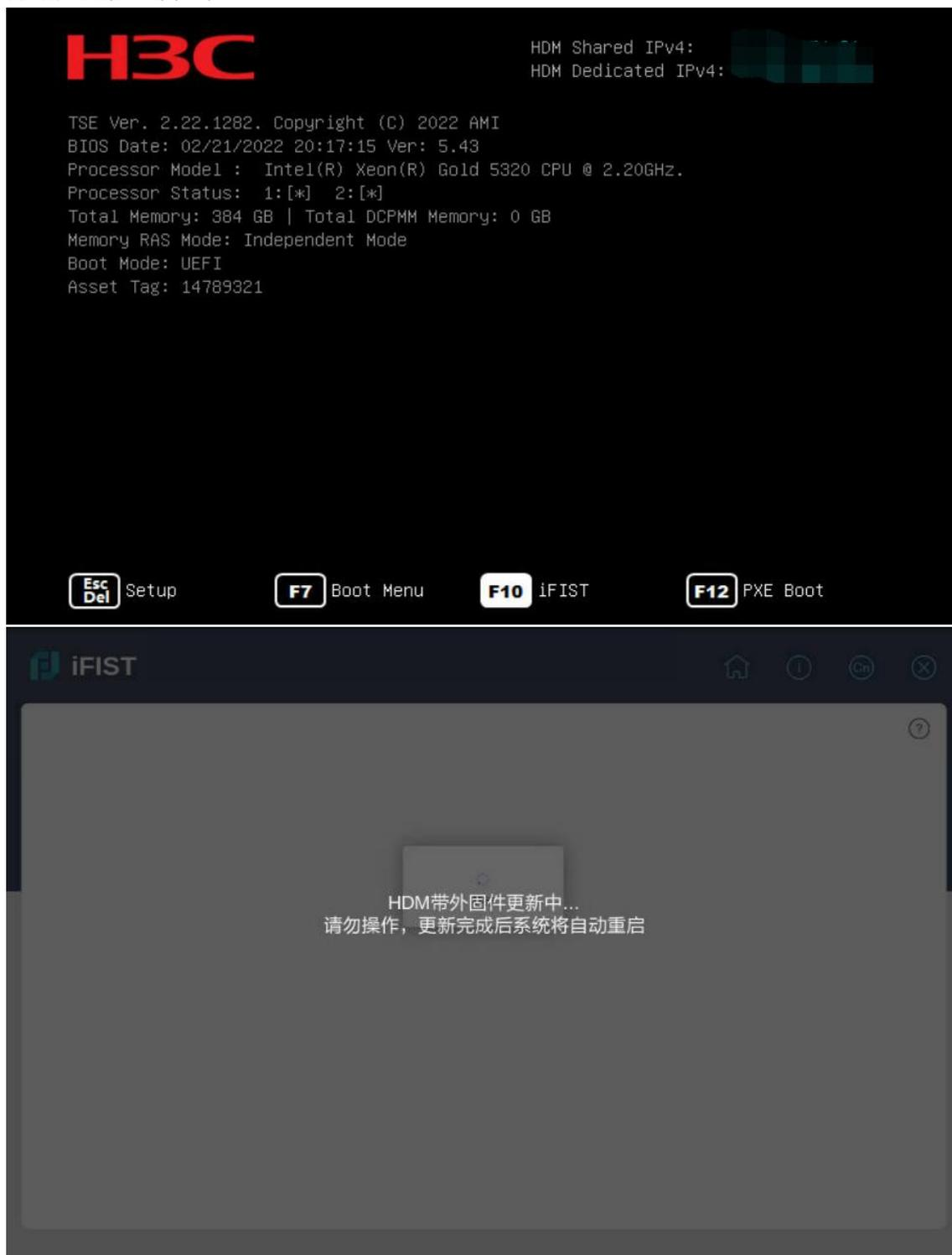
5) 固件更新结束后，将自动重启；对于已有操作系统的设备，将在重启后引导进入系统。
