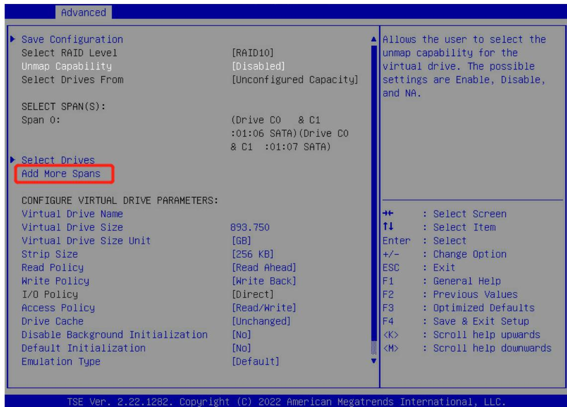
7) 所有 Span 设置完成后，选择 **Save Configuration** 完成配置，生成阵列。
