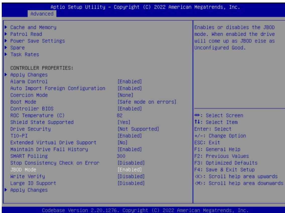
注：设置 JBOD Mode 为 Enabled 后，Unconfigured Good 状态的硬盘会自动切换为 JBOD，如没有自动切换，或 JBOD Mode 已为 Enabled 状态，需单独调整 Unconfigured Good 状态的硬盘为 JBOD，再执行步骤 2)。
