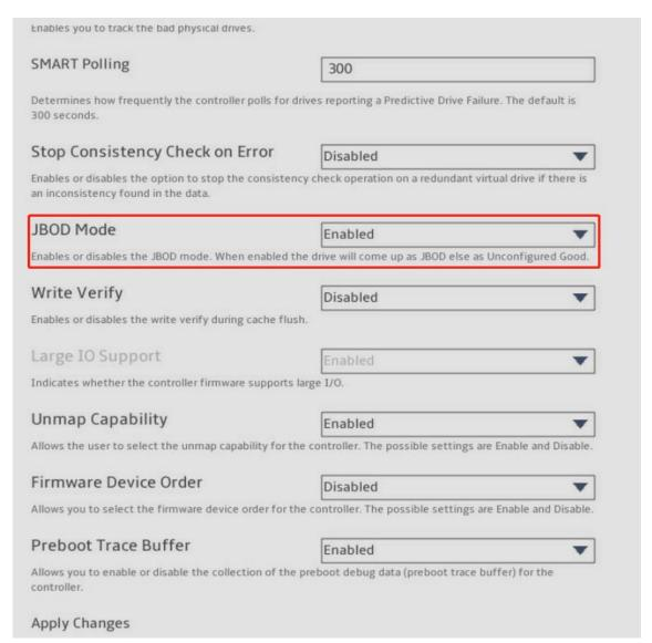
注:设置 JBOD Mode 为 Enabled 后, Unconfigured Good 状态的硬盘会自动切换为 JBOD, 如没有自动切换,或 JBOD Mode 已为 Enabled 状态,需单独调整 Unconfigured Good 状态的硬盘为 JBOD,再执行步骤 2)。
