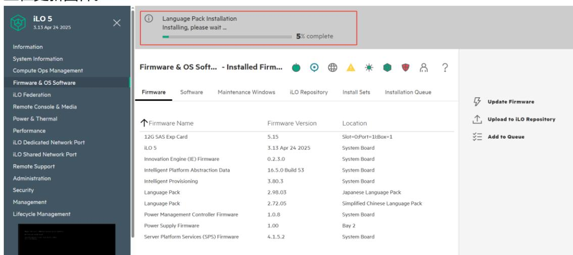
6) 更新完成后，将弹出“Firmware Update Completed”提示。服务器不会自动重启，iLO将自动重启，重新登录即可。
