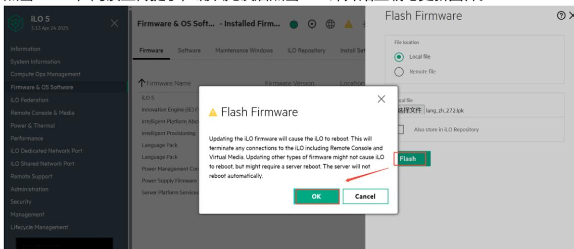
注：上图提示内容为“如果更新 iLO 固件，将导致 iLO 重新引导。这会终止 iLO 的任何连接，包括远程控制台和虚拟介质。更新其它类型的固件可能不会导致 iLO 重新引导，但可能需要重新引导服务器。服务器不会自动重新引导。”
