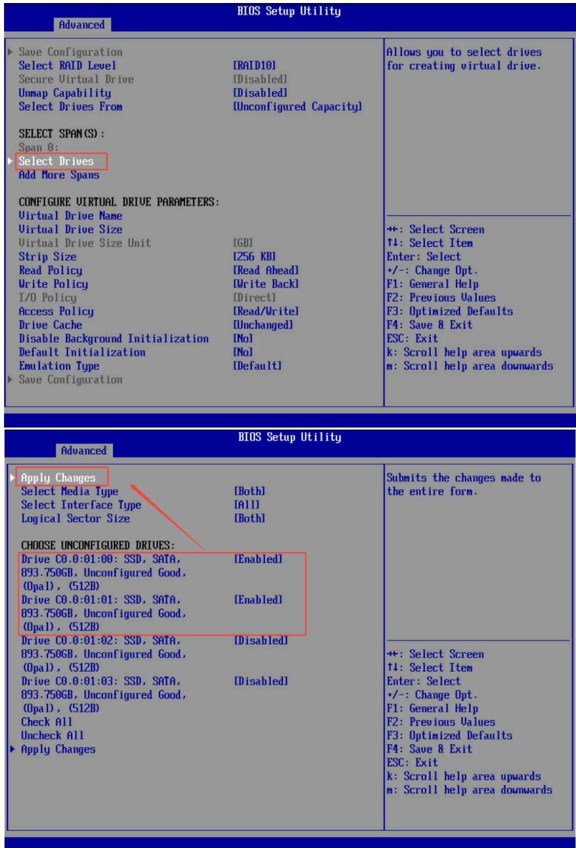
4) 在生成第一个 Span 后，选择 Add More Spans 添加第二个 Span 的成员盘，方法
