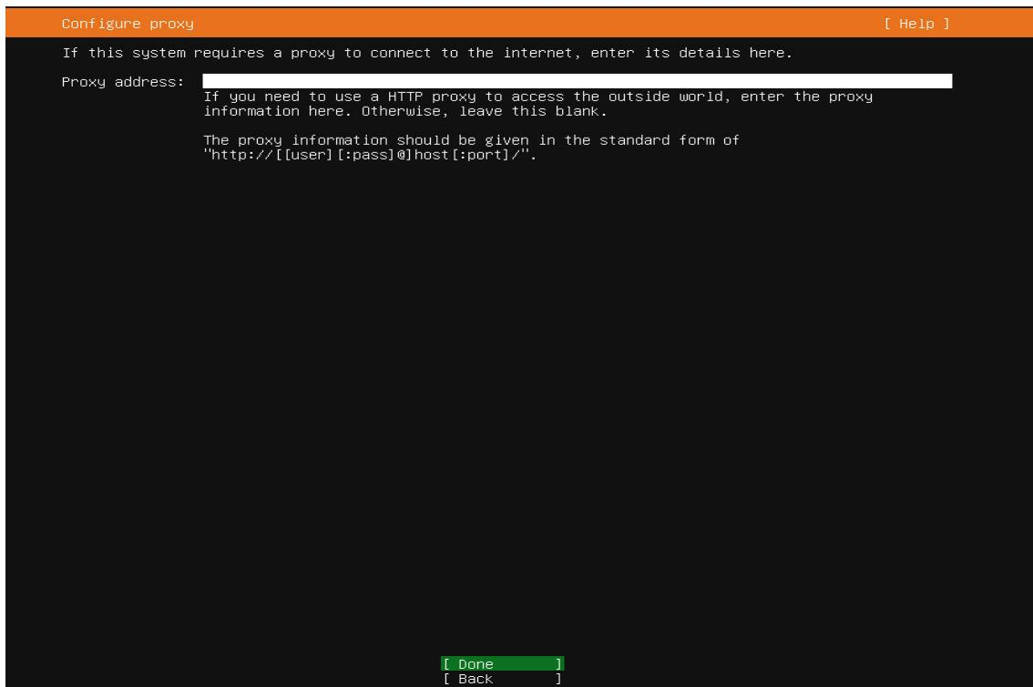
2.10 设置镜像源地址，在“Mirror address”输入框中输入镜像源地址，若无特殊要求默认后，选择“Done”按<Enter>键进入下一步。
