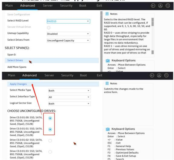
6) 在生成第一个 Span 后,选择 **Add More Spans** 添加第二个 Span 的成员盘,方法同上。
