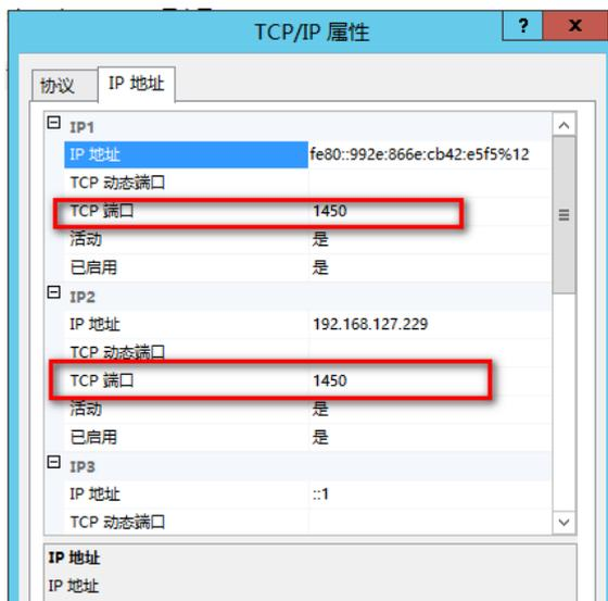
修改iMC对接数据库端口：（先停止H3C部署监控代理）
