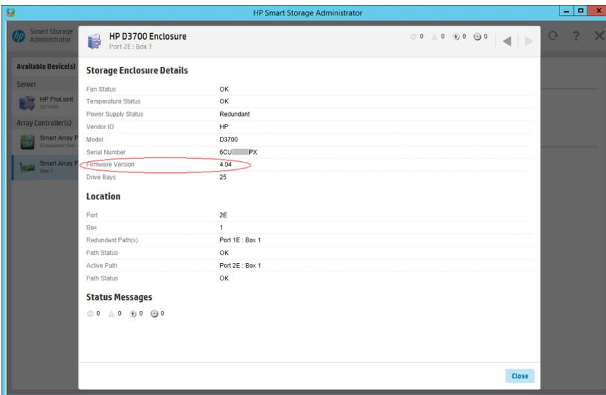
本次测试通过Smart Component对D3700固件进行升级，运行高版本固件4.12的Smart Component程序。
