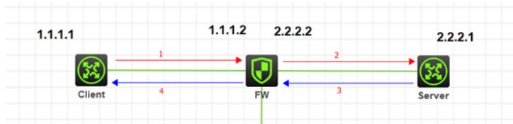
1，FW接收Client发出的请求报文：源IP-1.1.1.1，目的IP-2.2.2.1；
