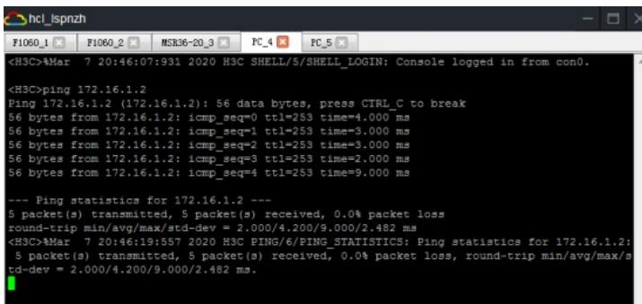
IPV4子网2的PC可以PING通IPV4子网1的PC：
