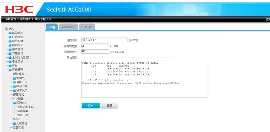
3.进一步检查，在ACG上无法学习到对端防火墙的ARP表项，检查两端地址配置发现对端防火墙将地址配置为了30位掩码的地址，导致ACG无法ping通直连地址，无法访问互联网。
