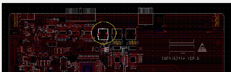
2、将交换板以下位置两个跳线使用跳线帽连接。
