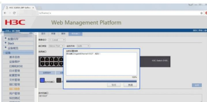
指定目的端口：选择“镜像组ID”、选择端口类型为“Monitor port”，在交换机面板选择“28”后点击应用，说明28口为目的端口。
