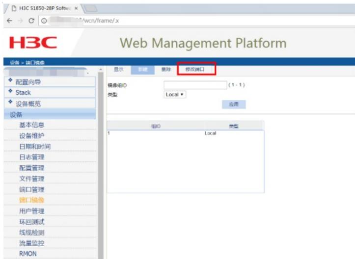
指定源端口：选择“镜像组ID”、选择端口类型为“Mirror port”，监控方向为“both”，在交换机面板选择“27”后点击应用，说明27口为镜像口。
