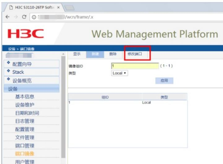
指定源端口：选择“镜像组ID”、选择端口类型为“Mirror port”，监控方向为“both”，在交换机面板选择“25”后点击应用，说明27口为镜像口。
