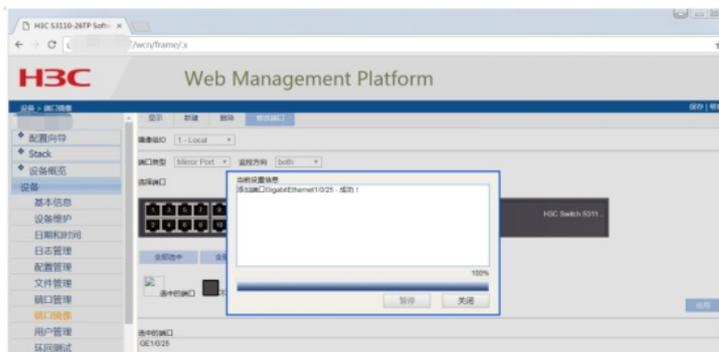
指定目的端口：选择“镜像组ID”、选择端口类型为“Monitor port”，在交换机面板选择“28”后点击应用，说明26口为目的端口。
