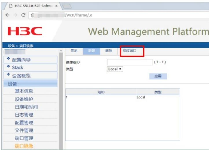
指定源端口：选择“镜像组ID”、选择端口类型为“Mirror port”，监控方向为“both”，在交换机面板选择“27”后点击应用，说明27口为镜像口。
