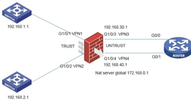
客户有多个业务网段，要求网段之间互访的控制不通过防火墙来做。流量二次穿过防火墙，流量控制在路由器上。以1.0和2.0为例。1.0网段访问2.0网段的流量需要通过访问映射映射后地址172.168.0.1来访问。
