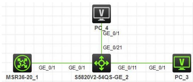
S5820作为DHCP中继交换机，有两个VLAN，分别是VLAN70，IP地址192.168.70.1，VLAN71，IP地址192.168.71.1，PC3所连接的端口GE\_0/11为access VLAN 70，Pc4所连接的端口GE\_0/21为access VLAN71，希望PC3获取到的IP地址为192.168.70.0网段地址，PC4获取到的IP地址为192.168.71.0网段地址，
