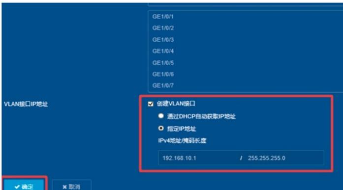
7) 在修改VLAN设置界面选中并点击GE1/0/10, 表示把此接口加入到VLAN 10里在“VLAN接口IP地址”选项这里选择“指定IP地址”，并配置好VLAN接口地址192.168.20.1，掩码为255.255.255.0
