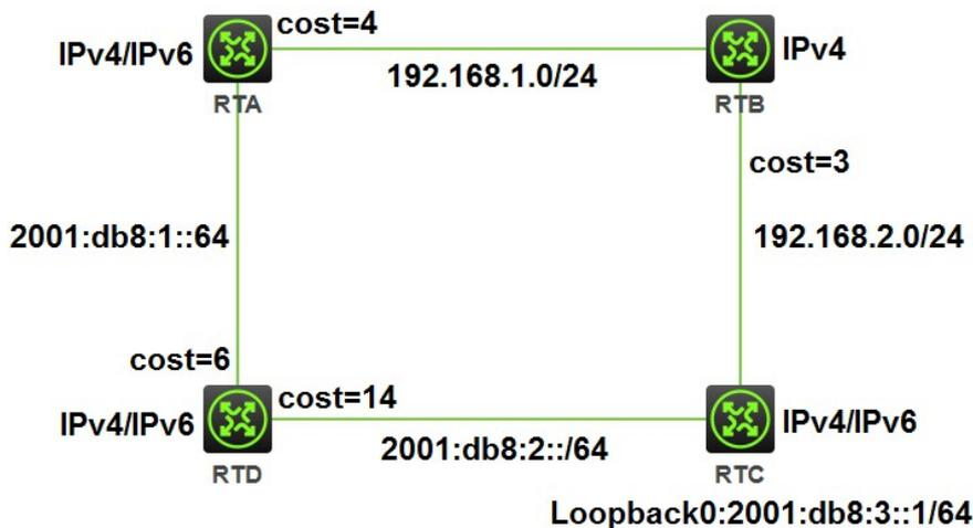
图中RTA、RTC和RTD支持IPv4和IPv6双协议栈；RTB只支持IPv4协议，不能转发IPv6报文。在RTA、RTC、RTD上配置IS-IS支持IPv6单播拓扑，对于IPv4、IPv6都分为两个拓扑进行计算，到RTC的Loopback0的IPv6地址不会转发给Router B而造成报文丢弃。
