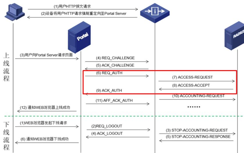
从抓包结果结合portal认证原理进行分析，我们可以看出portal服务器向AC发送认证请求REQ\_AUTH报文后AC直接回复了认证应答的ACK\_AUTH报文，跳过了本应该向radius服务器发起的接入请求和radius服务器允许接入应答的过程，即下图中过程（7）、（8）。
