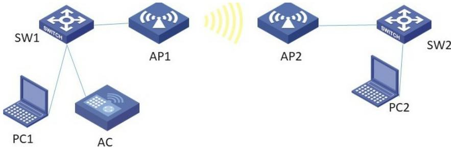
AP1和AP2瘦胖桥接，PC1和PC2分别有线连接交换机SW1和SW2，打流测速。
