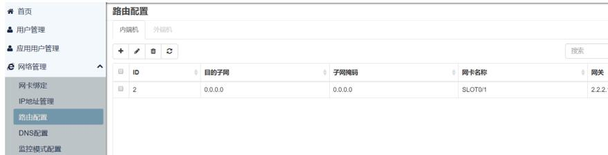
当在内端机添加第二条缺省路由时显示操作失败，当删除内端机已存在的默认路由后新添加的默认路由可以正常创建；
