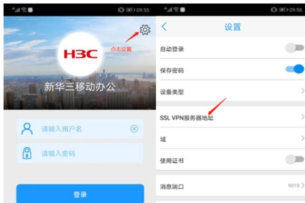
SSL VPN网关地址格式为: X.X.X.X:端口, 其中8443为SSL VPN服务端口, 设置完成后, 点击左上角返回, 输入账号密码进行认证。
