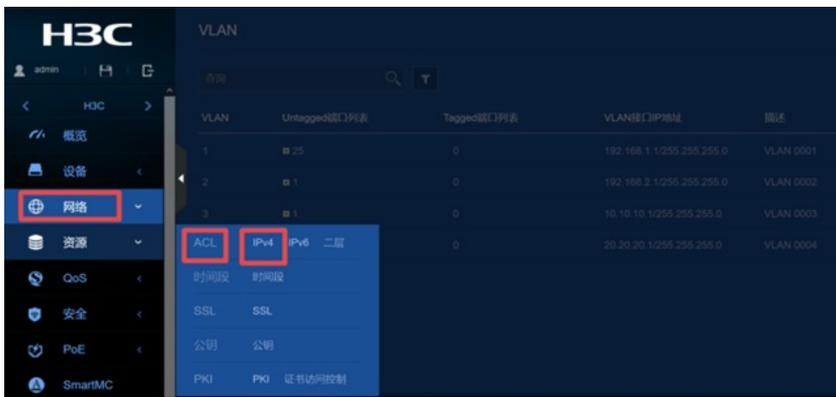
2) 添加IPv4 ACL>高级ACL>ACL，输入“3000”，点击“确定”
