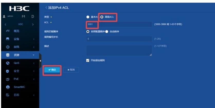
5) 添加IPv4高级ACL的规则，动作是“允许”，IP协议类型是“IP (256)”，勾选“匹配源IP地址/通配符掩码”，输入“192.168.2.0/0.0.0.255”，勾选“匹配目的IP地址/通配符掩码”，输
