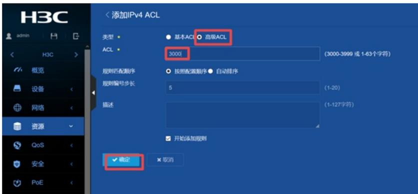
3) 添加IPv4高级ACL的规则，动作是“允许”，IP协议类型是“IP (256)”，勾选“匹配源IP地址/通配符掩码”，输入“192.168.2.0/0.0.0.255”，点击确定
