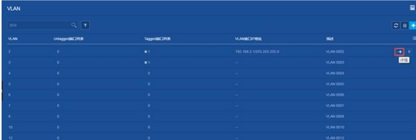
4) 在修改VLAN设置界面选中并点击GE1/0/6，点击右移的箭头，将此接口加如VLAN2，下面是添加接口成功的示意图
