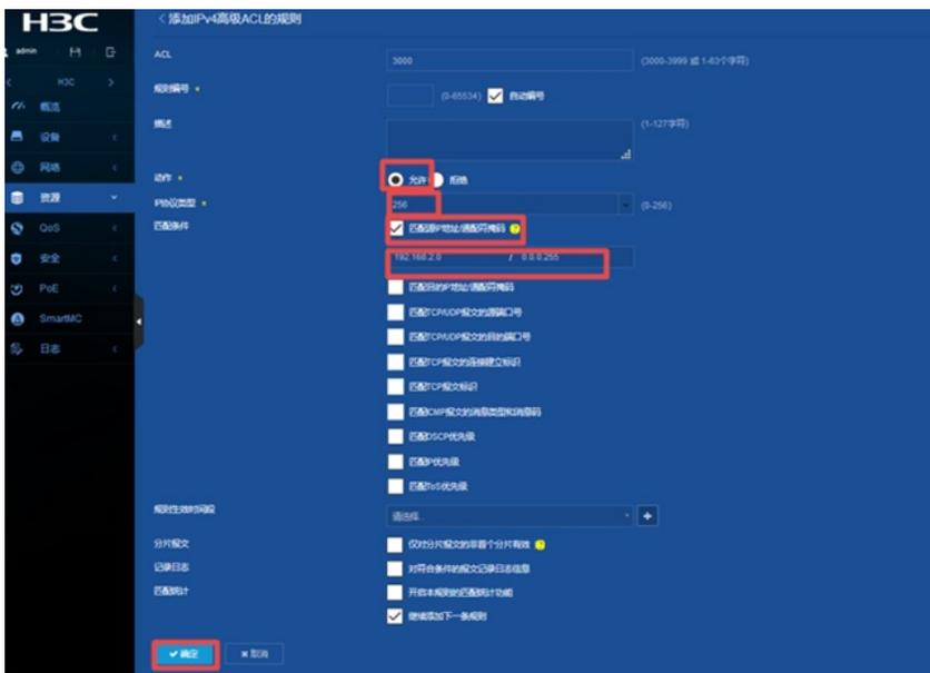
4) 添加IPv4 ACL>高级ACL>ACL，输入“3001”，点击“确定”
