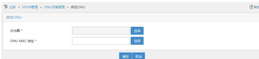
(3) 为ONU设备绑定分光器。单击<选择>按钮，在弹出选择分光器窗口中选择一个分光器，如图12所示。一个分光器可直接相连多个ONU设备。
