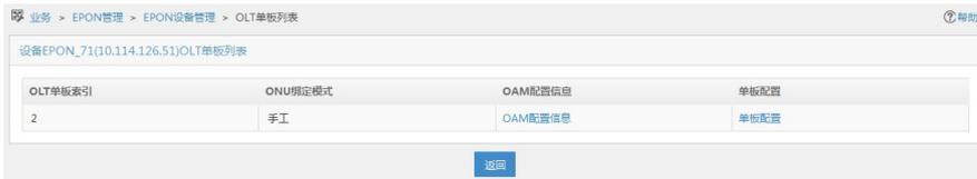
(2) 点击“OLT单板列表”的“OAM配置信息”链接,进入OAM配置信息页面,如图4所示。页面可配置对应单板的OAM超时时间、OUI值和OAM版本号。OAM发现超时时间,即OAM发现过程中OLT与ONU之间交互的OAM消息的超时时间。
