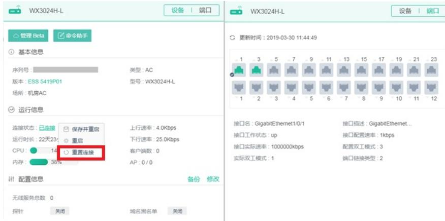
当鼠标悬停在线设备的“连接状态”处时，可对设备进行重启、重置连接等操作（重置连接即重置设备与绿洲平台的云连接，点击“重置连接”后设备先断开云连接，而后重新连接绿洲平台）。
