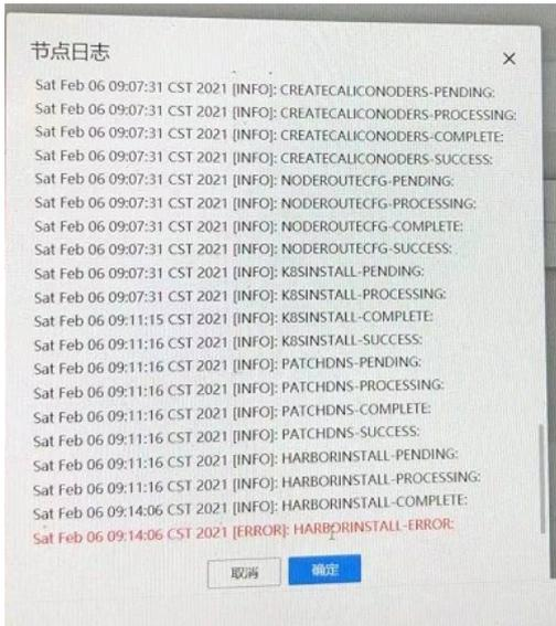
matrix已知问题，现场SDN控制器上存在无用的网卡配置了IP地址导致，《H3C SNA Center安装及组件部署指导-E12xx-5W208.pdf》有相关说明。
