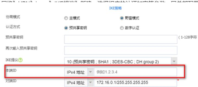
分支IKE策略--对端ID必须配置ipv4地址，因为分支要主动发起必须知道总部地址，另外如果分支对端ID配置成策略的本地策略配置如下。
