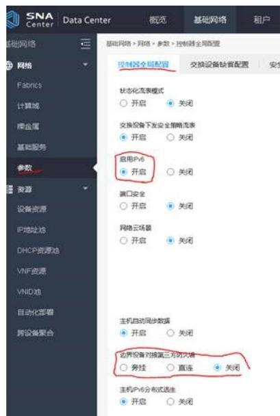
由于ipv6全局开关开启，控制器尝试分配了ipv6类型的地址，由于现场没有ipv6类型的地址，导致分配失败
