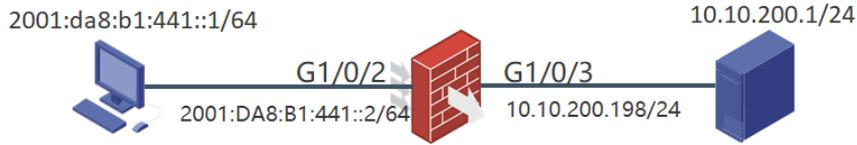
IPv6网络客户端通过防火墙去访问Internet IPv4服务器，防火墙互联接口、客户端及服务器地址如图所示。
