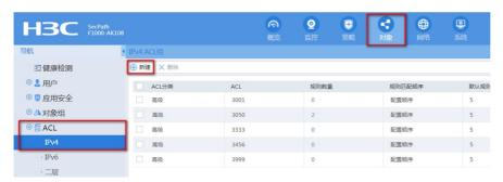
类型选择高级ACL, ACL编号填写一个3000-3999中和已存在的不冲突的
