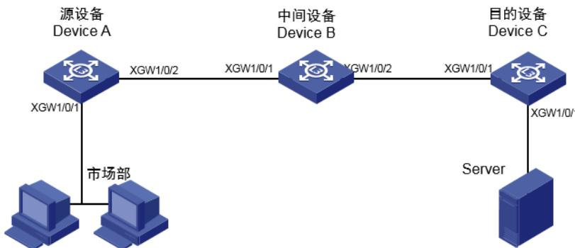
如图所示，Device A与Device C设备通过多跳的三层网络互联，监控Server挂在了远端Device C的下面，现Server需要监控Device A下面1/0/1端口的流量。
