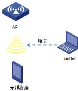
无线终端与AP之间复现问题时，插有无线抓包网卡Netgear A6210的PC使用omnipeek空口抓包软件抓包
