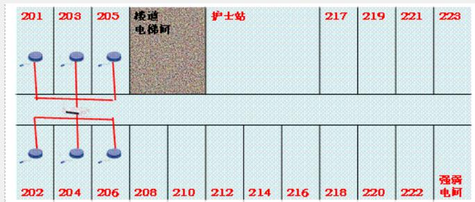
从降低商务和工程成本的角度, 可考虑采用大功率(500mw)AP, 11G模式和11N模式都有大功率设备, 根据需求决定, 在部署上没有区别。
